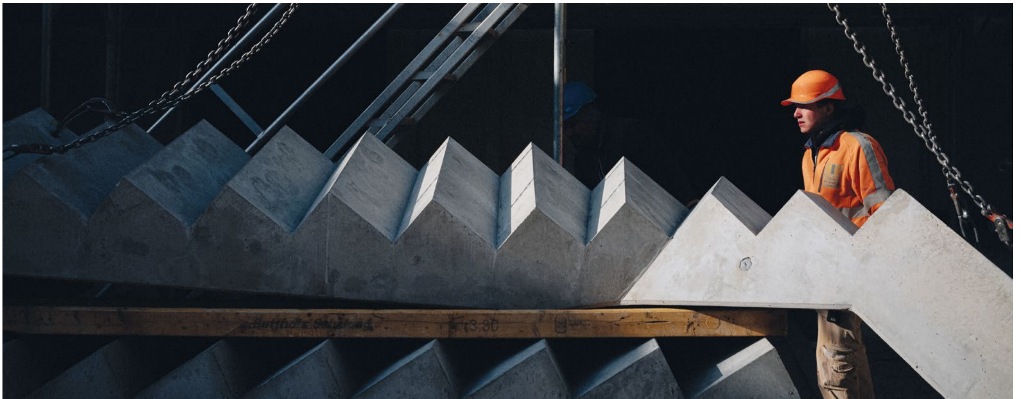
Rund 100 Treppenelemente werden für den Vogelsang produziert. Sie kommen in den unterschiedlichsten Ausführungen. Bilder: MA
