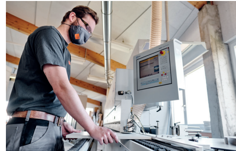
Mit der Kantenleimmaschine werden die ABS-Kanten angebracht, die die Kanten schützen.
