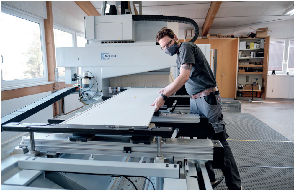
Der Schreiner, Marco Spescha, bereitet die Spanplatten für die CNC-Maschine vor. Bilder: MR
