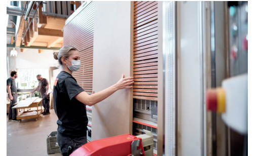
Schreinerin Lisa Wingeier schneidet die Holzplatten stehend zu – vor allem aus Platzgründen.
